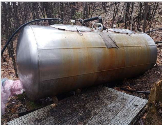
Figure 3 – Réservoir de 500 GUS
